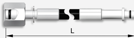
Cabrio-Verdeck Hydraulik-Schlauchleitung Typ CA15 Anschlüsse: Typ A05, RA 6/Typ P306B
