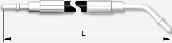
Cabrio-Verdeck Hydraulik-Schlauchleitung Typ CA32 Anschlüsse: Typ MCAB1/Typ MCAB2
