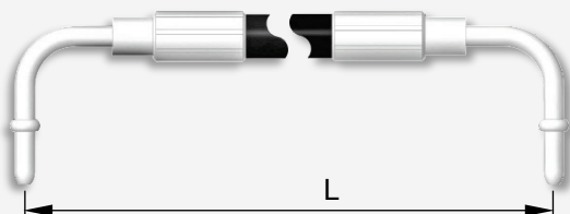
Cabrio-Verdeck Hydraulik-Schlauchleitung Typ CA35 Anschlüsse: Typ MCAB3/Typ MCAB3
