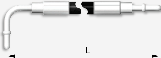
Cabrio-Verdeck Hydraulik-Schlauchleitung Typ CA34 Anschlüsse: Typ MCAB3/Typ MCAB1
