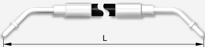
Cabrio-Verdeck Hydraulik-Schlauchleitung Typ CA33 Anschlüsse: Typ MCAB2/Typ MCAB2
